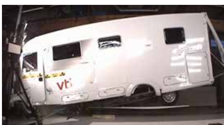
Figur 16. Överbyggnad lossat från chassi
